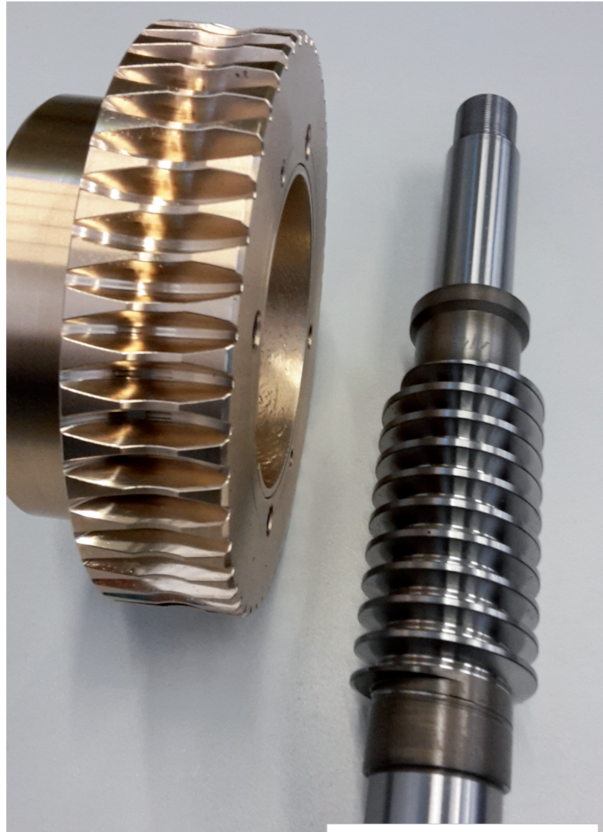
Beispiel eines Radpaares aus einer Zylinderschnecke und einem Globoidrad, m = 3,8522 Duplex, 1gg links, erreichte Qualität Q1 DIN 3974.
